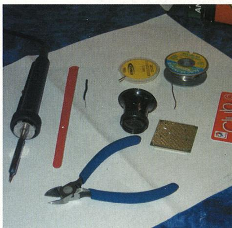
Le matériel nécessaire pour bien travailler. Fer à souder, lime à ongle, pince à dessouder, étain, loupe de contrôle
